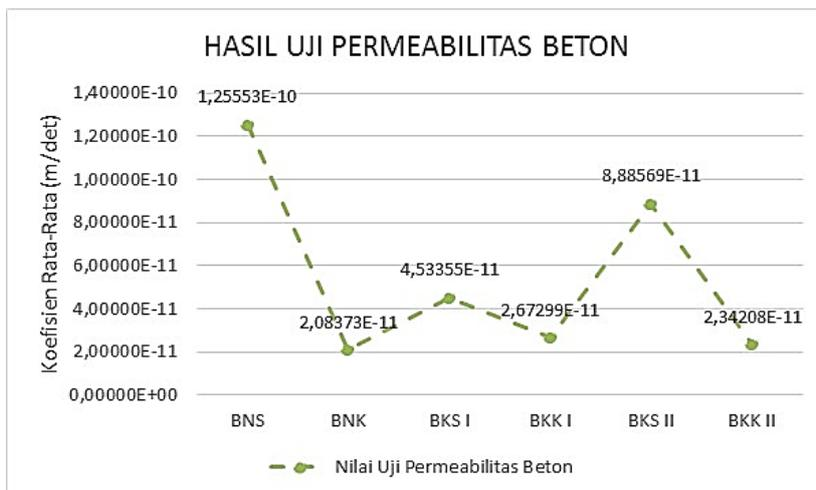
**Gambar 3.6.** Grafik Hasil Permeabilitas Beton Umur 28 Hari (Sumber: Hasil Analisa)
